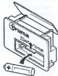
Sejměte opláštění topení (viz bod 1), kryt přihrádky pro baterii vysuňte směrem nahoru a baterii vyměňte. Dodržujte pólování (plus/minus). Přihrádkou pro baterii opět uzavřete
